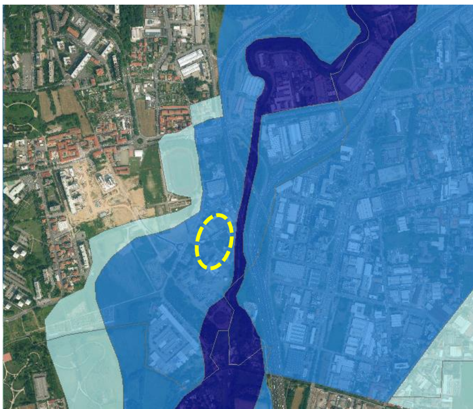
Figura 27 La cartografia delle aree a diversa pericolosità nella zona esaminata: L – scenario raro – azzurro chiaro, M – scenario poco frequente – azzurro scuro, H – scenario frequente - blu (da Geoportale Lombardia).
